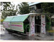
Dénommée « Éco point mobile », la petite déchetterie de Sepra environnement s'articule autour d'une remorque peu encombrante et facile à mettre en place grâce à un véhicule de type fourgon. Avec une capacité de 1,5 tonne, elle représente une solution de proximité dans le traitement des petits déchets : cartouches de toner, petits électroménagers, téléphones portables, peintures, piles, radios, lampes, etc.
