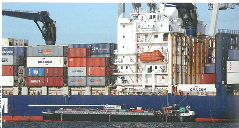
Dédiée à la collecte des déchets d'exploitation liquides, la barge de 400 m 3 de SWC, Service Waste Collection, Sarp Industries.
