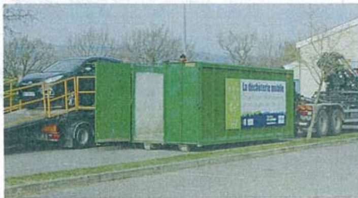
Les voitures passent sur la remorque, transformée en passerelle, et jettent leurs déchets dans les bennes correspondantes
